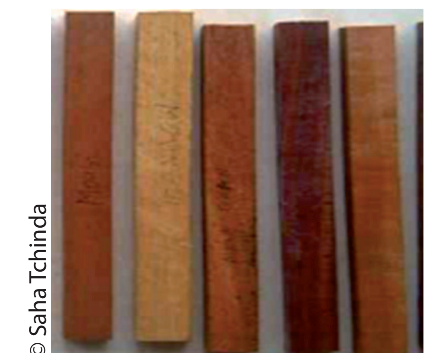
Figure 4. Pour chaque essence nous réalisons 12 éprouvettes de 25 x 15 x 5 mm 3 pour les essais en laboratoire (à gauche) et 200 x 20 x 20 mm 3 pour les essais en champs (à droite) selon les directions longitudinale, transversale et tangentielle
