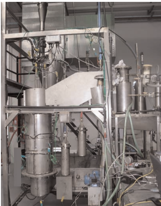
Réacteur pilote du Cirad. Lit fluidisé d'une capacité de 1 kg/h.
