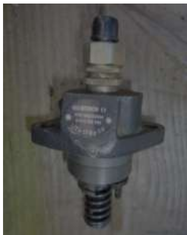
Figure 14 : exemple de pompe unitaire (©Gilles VAITILINGOM, 2013)
