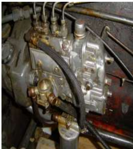
Figure 15 : exemple de pompe en ligne (©Gilles VAITILINGOM, 2013)
