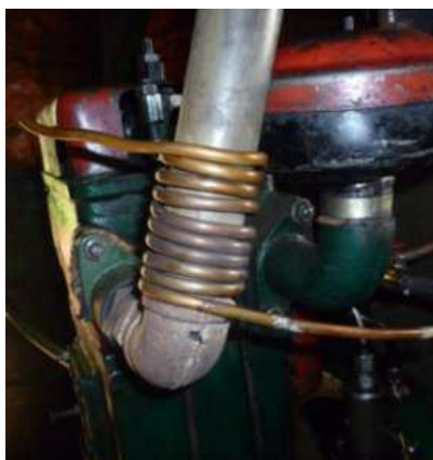
Figure 27 : montage d'un réchauffeur d'huile végétale (©William FOTSEU, 2010)
