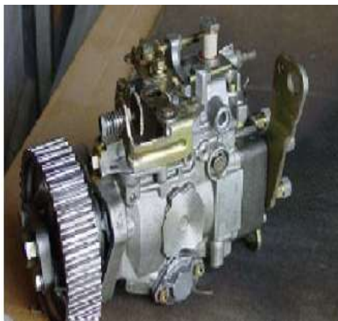
Figure 16 : exemple de pompe rotative (©Gilles VAITILINGOM, 2013)
