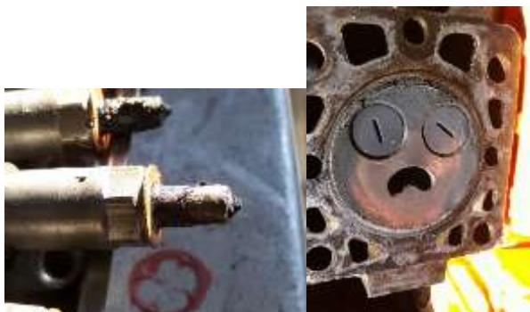
Figure 22 : dépôts carbonés sur le nez des injecteurs et la culasse (©Gilles. VAITILINGOM, 2013).
